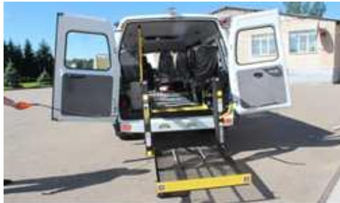
Рис. 27 и 28. Автомобили, оборудованные подъемниками для инвалидов, АУ СО ВО «Психоневрологический интернат «Сосновая Роща»
