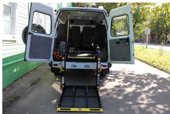
Рис. 19 и 20. Автомобили, оборудованные подъемниками для инвалидов, БУСО ВО «Комплексный центр Устюженского района «Гармония»
